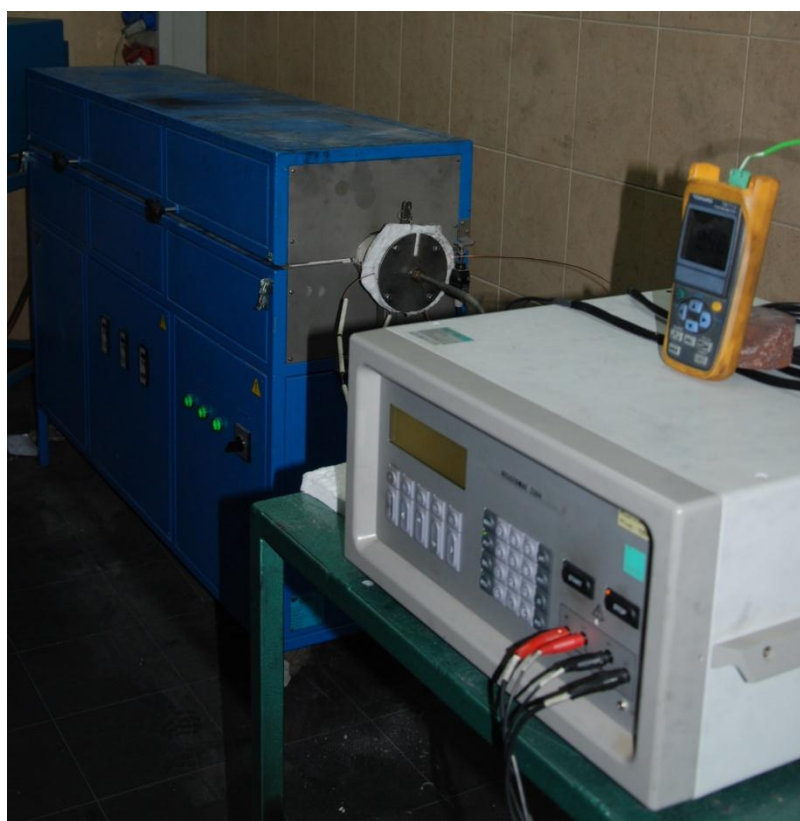
Rysunek 4. Stanowisko do badań własności elektrycznych drutów w podwyższonych temperaturach.
