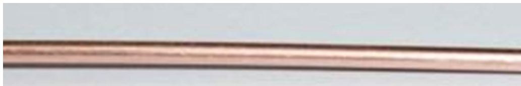
Rysunek 1. Drut w gat. CuOFC do badań własności elektrycznych.
