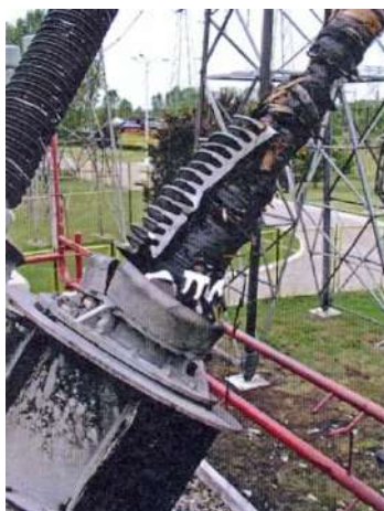
Rys. 6. Izolator na napięcie rzędu 400 kV po eksplozji [1] Fig. 6. Isolator of the range 400 kV after explosion [1]
