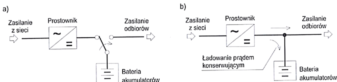
Rysunek 1. Układy współpracy akumulatorów z prostownikiem zasilacza UPS [1]: a) praca cykliczna b) praca buforowa.
