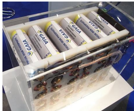
LiFePO 4 - układ baterii GAIA Źródło: www.solar-sicherheit.de
