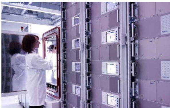
Stanowisko testowania baterii do 1000kW (do 1000A), Źródło: FuelCon
