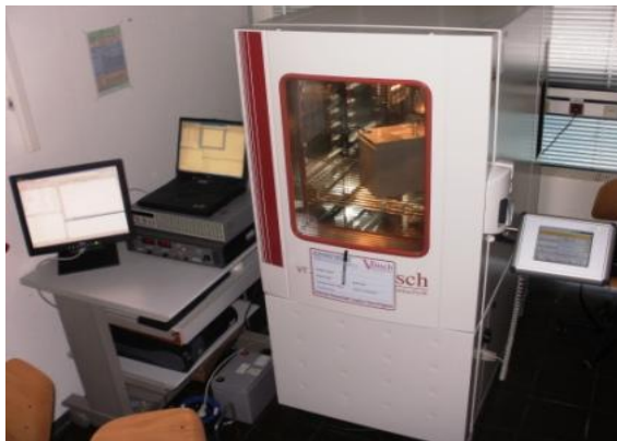
Stanowisko testowe z komorą o regulowanej temp.
