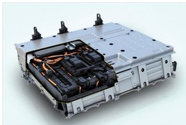
Bateria PH Toyota Prius z wewnętrznym chłodzeniem, Źródło: Autonews
