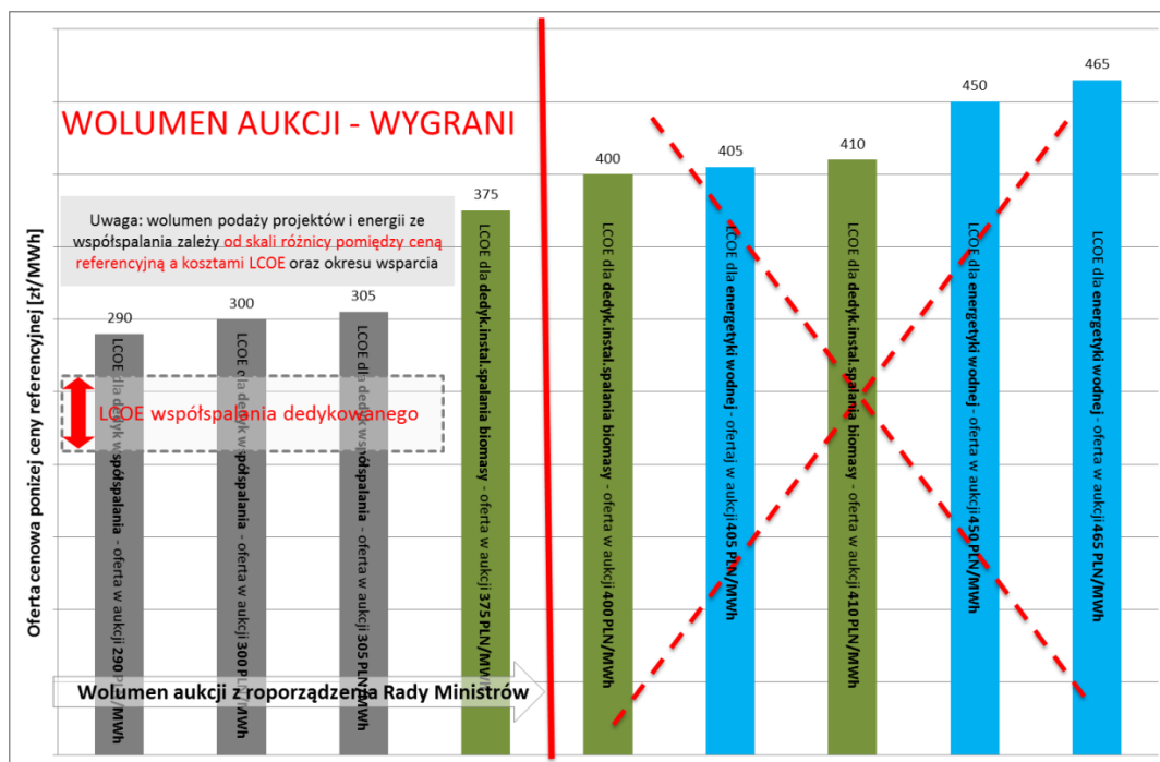
Rys. 3.: Wizualizacja uszeregowania wg ceny energii (merit order) projektów zgłoszonych do koszyka aukcyjnego oraz wskazanie zwycięzców aukcji.
