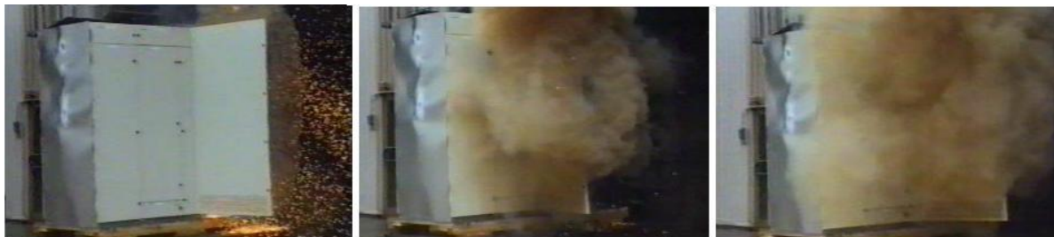
Rys. 3. Eksplozyjna emisja gazów i pyłów połukowych w wyniku zwarcia łukowego
