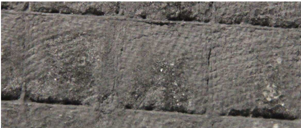
Rysunek 7 — Zasiarczenie płyty ujemnej akumulatora kwasowo-ołowiowego
