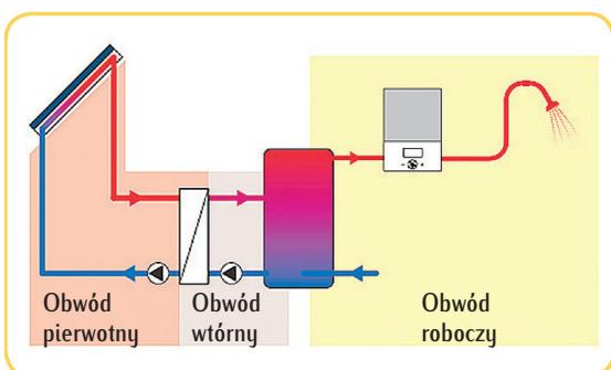
Zgodnie z warunkami technicznymi z uwagi na wysokie temp. dochodzące do 180<sup>o</sup> C, w obwodzie pierwotnym dopuszczalne jest tylko stosowanie rur miedzianych, w których poszczególne odcinki łączone są lutem miękkim lub twardym oraz stali nierdzewnej z połączeniami gwintowanymi, spawanymi lub kołnierzowymi, zabezpieczonymi z wierzchu farbą antykorozyjną.
