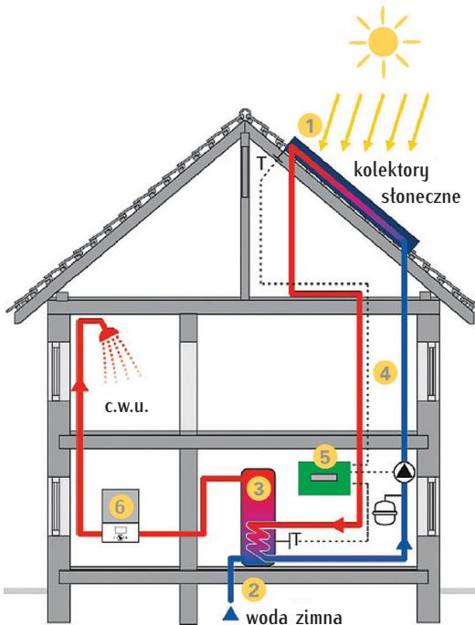
4. Obwód hydrauliczny, służący do przepompowywania ciepłej wody do zbiornika magazynowego.
